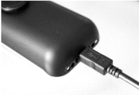
USB-Kabel den USB-Anschluss des Telefons anschließen. Das andere Ende des USB-Kabels am Netzteil oder einem USB-Anschluss anschließen.
