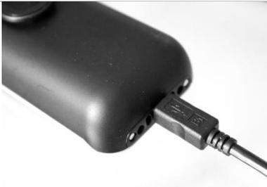
USB-Kabel den USB-Anschluss des Telefons anschließen. Das andere Ende des USB-Kabels am Netzteil oder einem USB-Anschluss anschließen.
